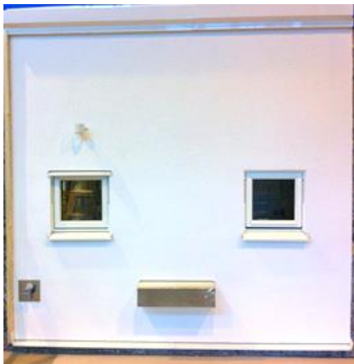
Figur 2. Exempel på en kommersiell provvägg (storlek 3 x 3 m) med fasaddetaljer; fönster, balkong och två infästningar (markis- och stuprörsinfästning).
